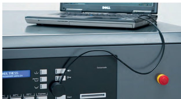
PC-Schnittstelle für das einfache Programmieren von Waschprogrammen
